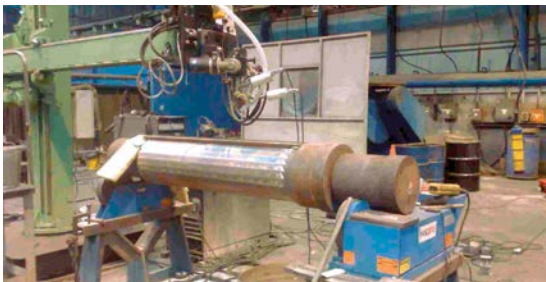
Forging – Punching Tools (Alloy C276) Soudotape NiCrMo59 + Record EST 259 Soudotape NiCrMo4 + Record EST 259
