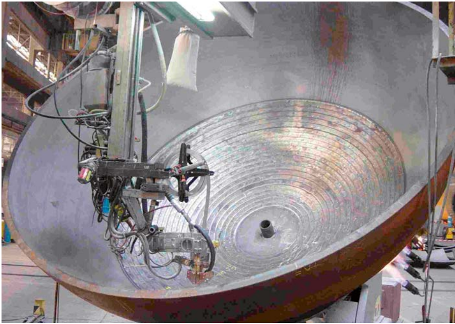
High pressure separator (Nickel alloy 825) Soudotape 825 + Record EST 138
