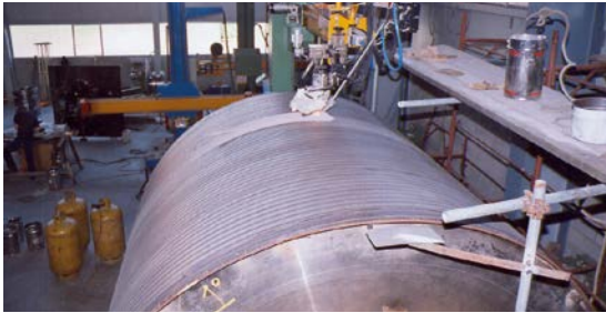
Paper Rolls (Alloy 14Cr2Ni1Mo) Soudotape 430 + Record EST 452
