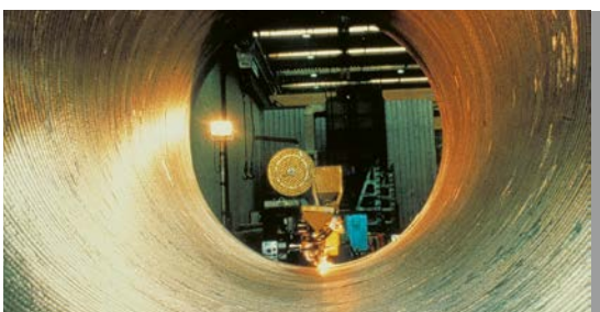
Separator Vessel (Nickel alloy 625) Soudotape 625 + Record EST 201
