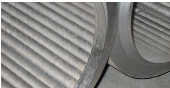
Pipes (Nickel alloy 825) Soudotape 825 + Record EST 236
