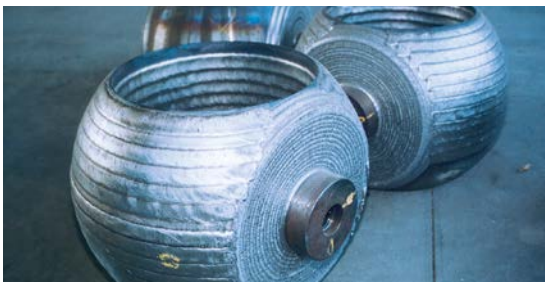
Ball Valves (Nickel alloy 625) Soudotape 625 + Record NFT/EST 201
