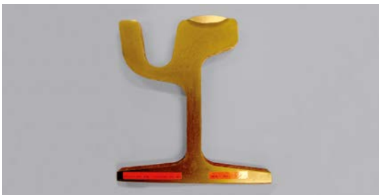
Rails (Alloy 317L) Soudotape 309L + Record EST 307
